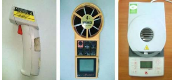
Figura No 4. Equipos de medición: Termómetro infrarrojo, anemómetro, balanza infrarroja
