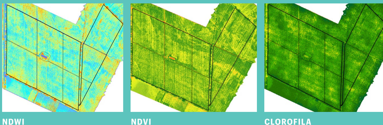
Figura 8: Índices vegetativos obtenidos con sensor multiespectral
