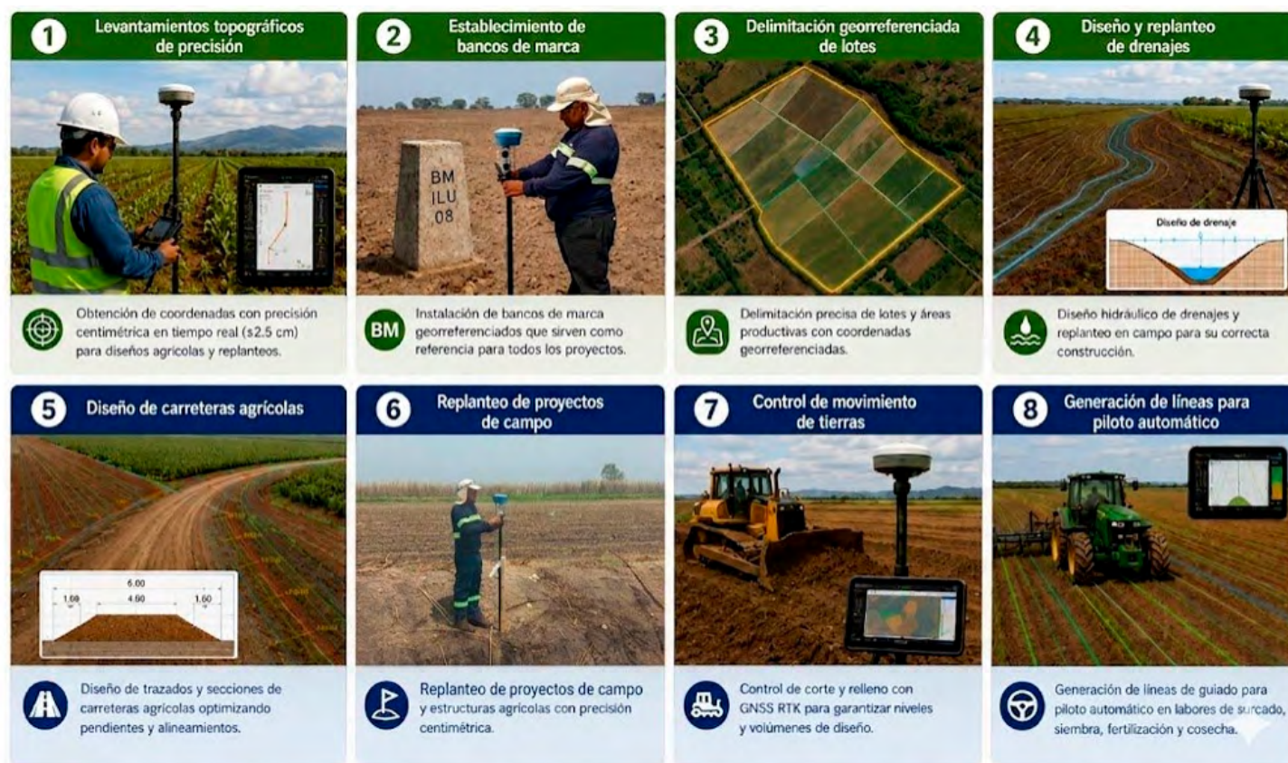
Figura 2: Topografía con GNSS RTK aplicada al diseño agrícola
